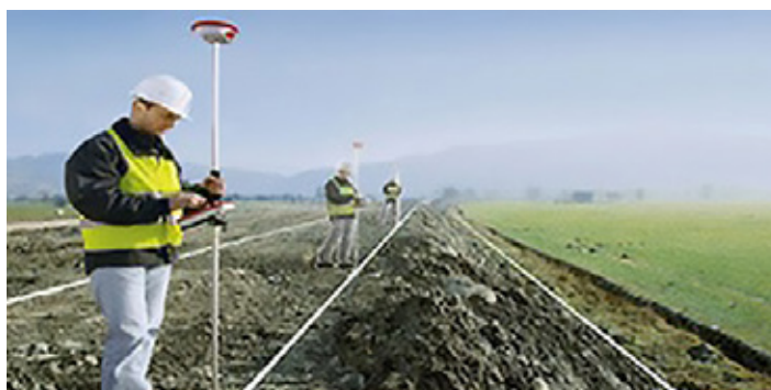
Figura 8 – Levantamento de informações altimétricas com GPS
