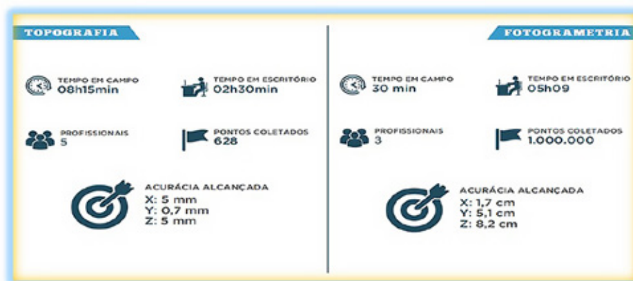
Figura 18 – Comparativo Topografia x Fotogrametria com VANT
