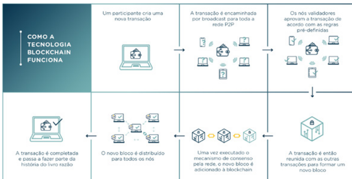
Figura 2. Funcionamento genérico de uma Blockchain
